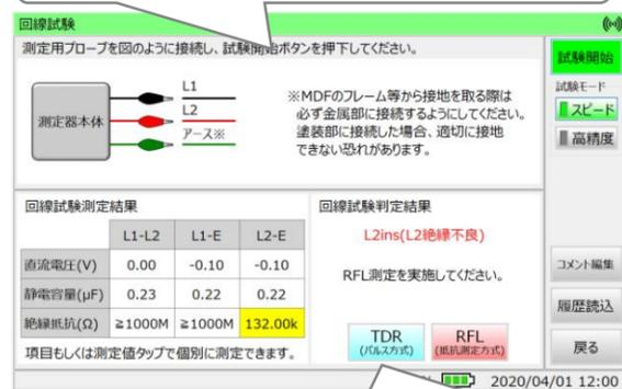
回線状態を自動判定! 故障箇所特定に適した測定方法をガイダンス
