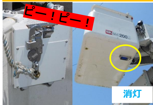
安全フック取付NG【表示灯 消灯】
